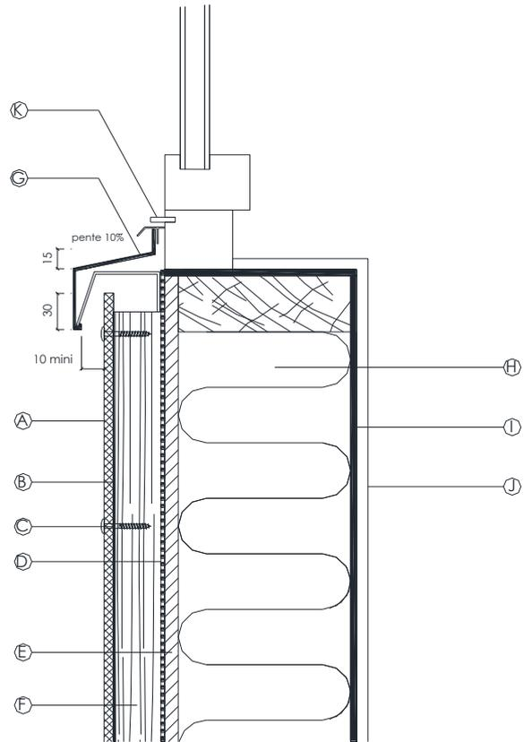
**Figure 25 – Pose sur COB – Coupe sur appui de baie**
