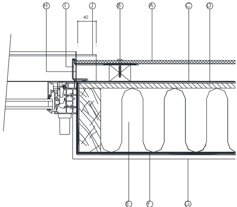
**Figure 26 – Pose sur COB – Coupe sur tableau de baie**
