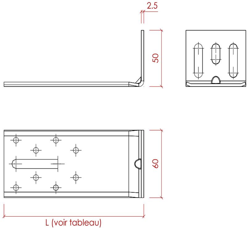
**Figure 4 – Patte-équerre (exemple ETANCO ISOLCO 3000P)**
