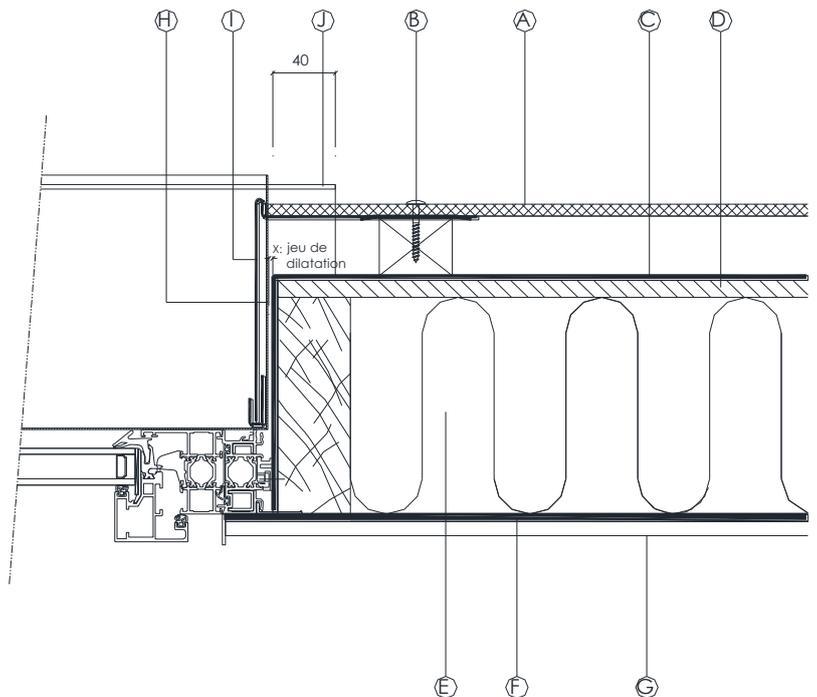
**Figure 22 – Pose sur COB – Coupe sur tableau de baie**
