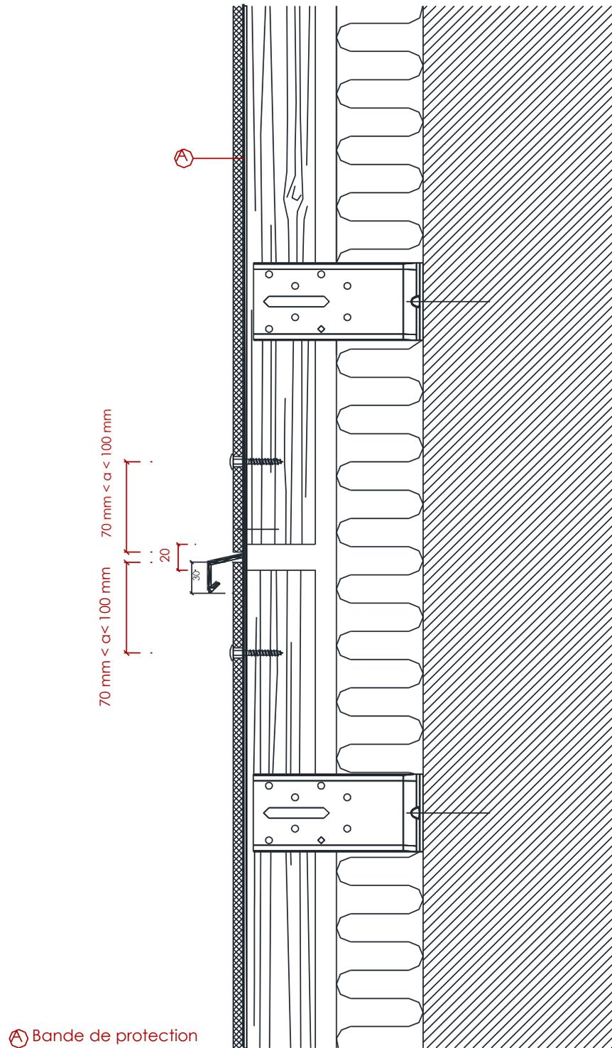
**Figure 16bis - Fractionnement de l'ossature pour des montants d'une longueur  $\geq 5,4$  m**
