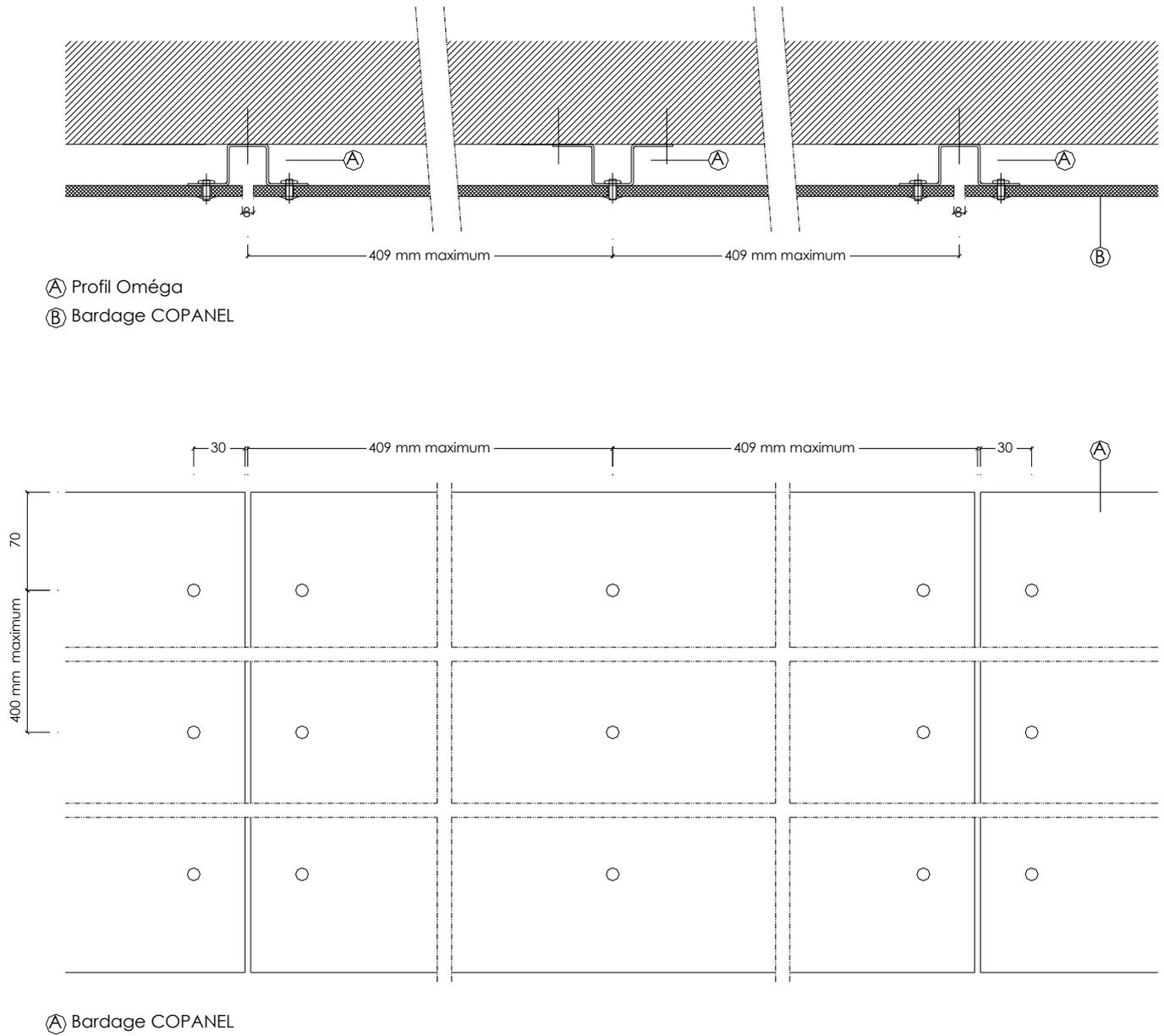
**Figure 51 - Pose en sous-face de dalle**
