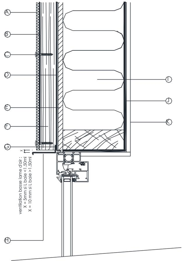
**Figure 24 – Pose sur COB – Coupe sur linteau de baie**
