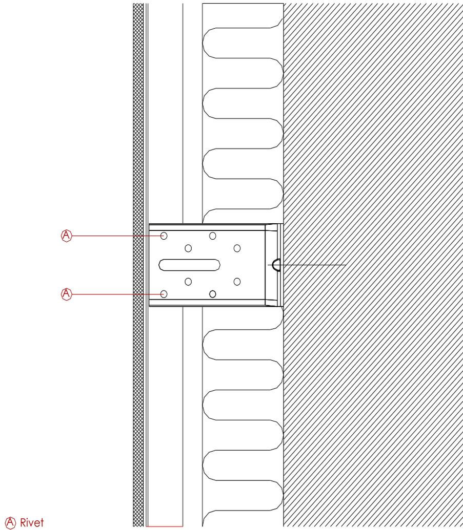
**Figure 37 - Pose de l'ossature métallique**
