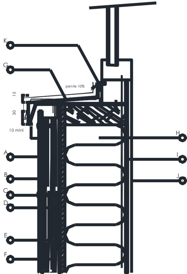
**Figure 21 – Pose sur COB – Coupe sur appui de baie**
