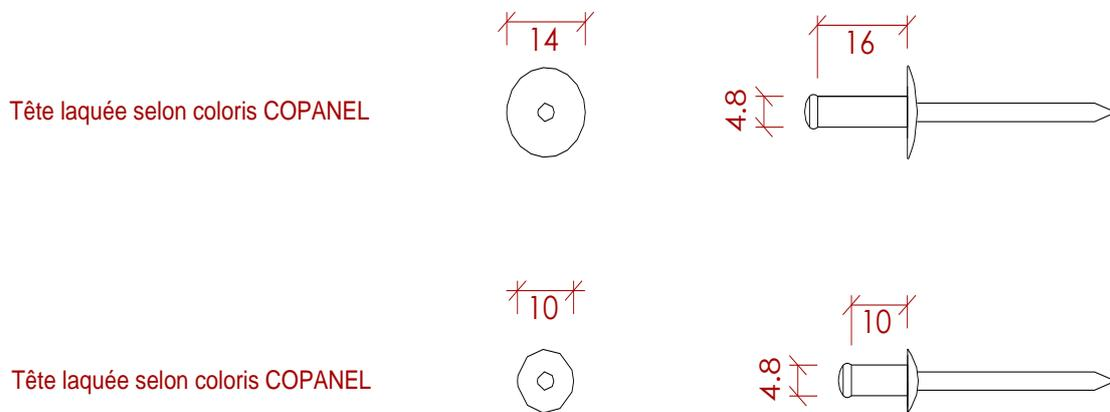
**Figure 33 - Rivets de fixation sur ossature acier**
