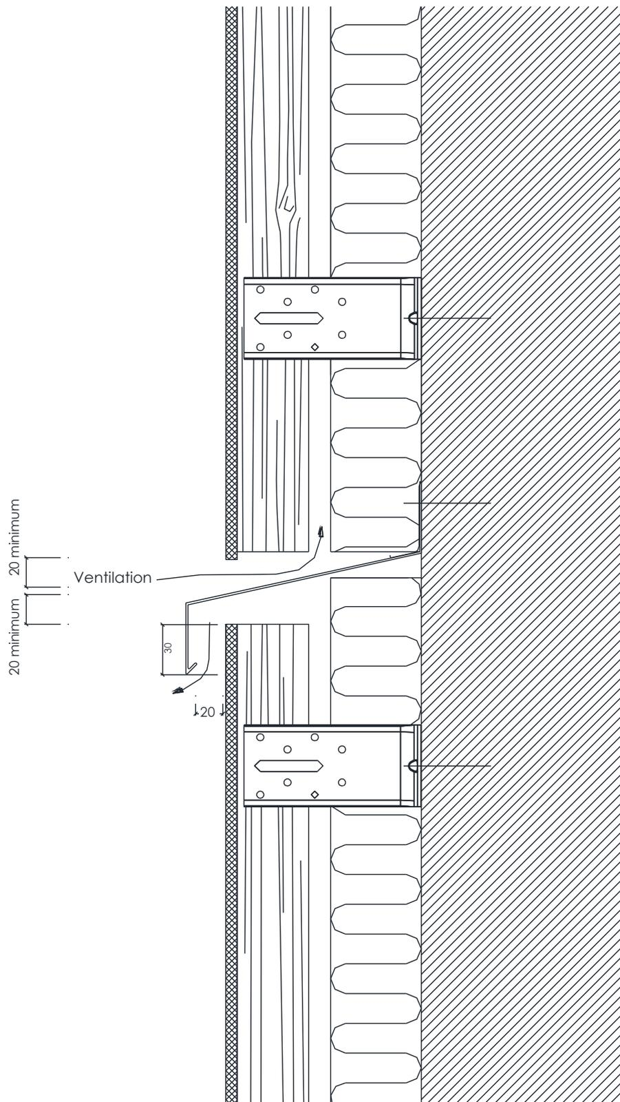
**Figure 15 - Fractionnement de la lame d'air**
