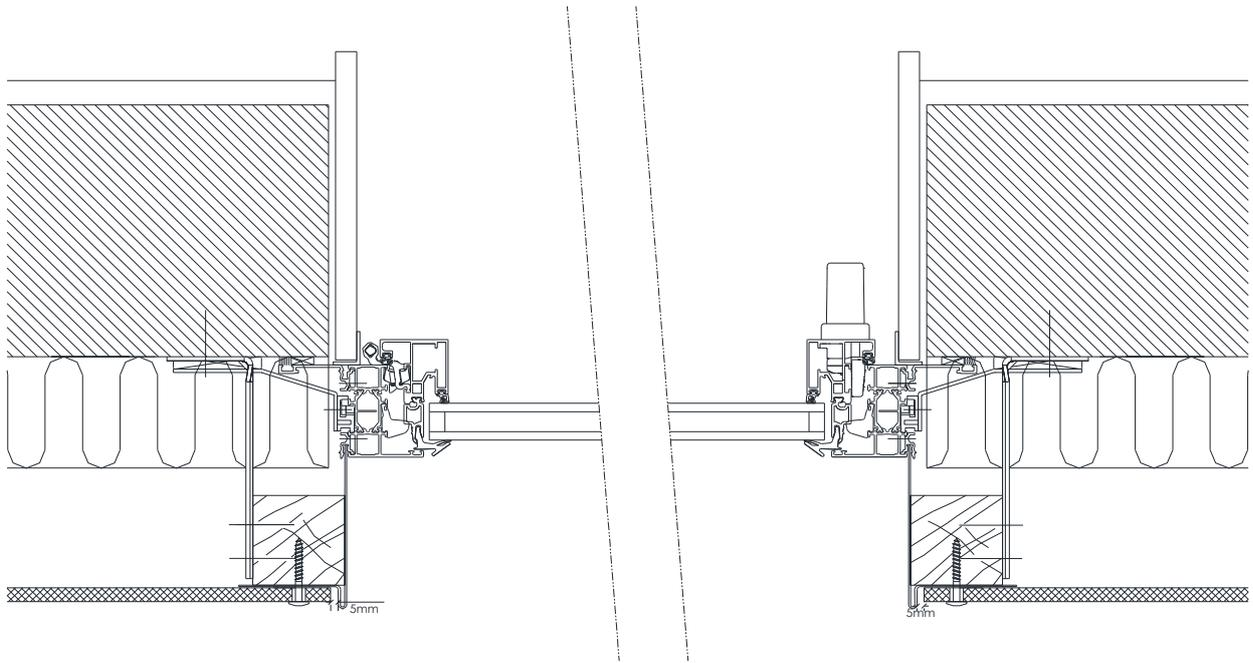
**Figure 14 - Encadrement de fenêtre (coupe sur tableau)**
